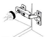
3. Регулировка по глубине
