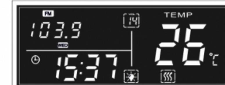
Нажмите кнопку ④, чтобы включить функцию воспроизведения музыки Радио. В верхней части экрана отобразиться значок диапазона FM и частота. Произведите настройку частоты кнопками ① и ②. Система сохранит настройки выбранной частоты при кратком нажатии кнопки .
