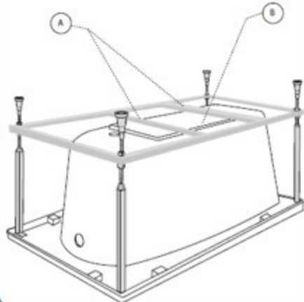
Рис.1: Схема сборки опорного каркаса и его монтажа к ванной
